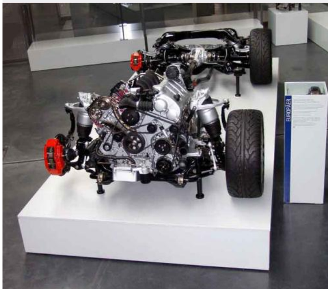
Cayenne-Antriebsstrang mit Teilschnitten, 2003
